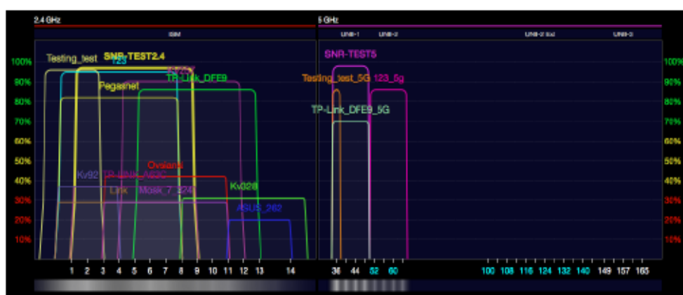
Wi-Fi анализатор показывает Wi-Fi эфир, на каком канале работают сети и уровень их сигнала. Так выглядит анализатор Wi-Fi Explorer на Mac OS
