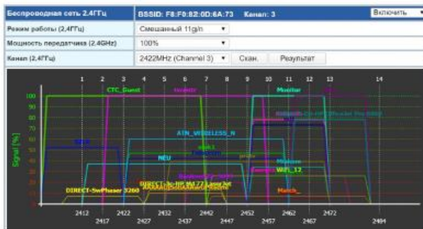
Так выглядит встроенный Wi-Fi анализатор на маршрутизаторе SNR-CPE-ME1
